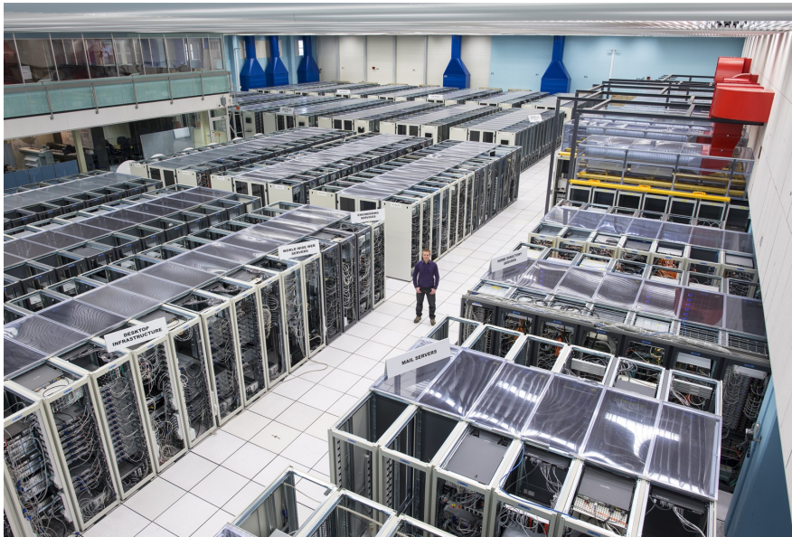
Le système de stockage du CERN EOS Open Storage. http://eos.web.cern.ch/ Les expériences du LHC produisent de l'ordre de 90 pétaoctets de données par an.
